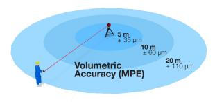
\*Measurement of a ScaleBar per ASME B89.4.19-2006
